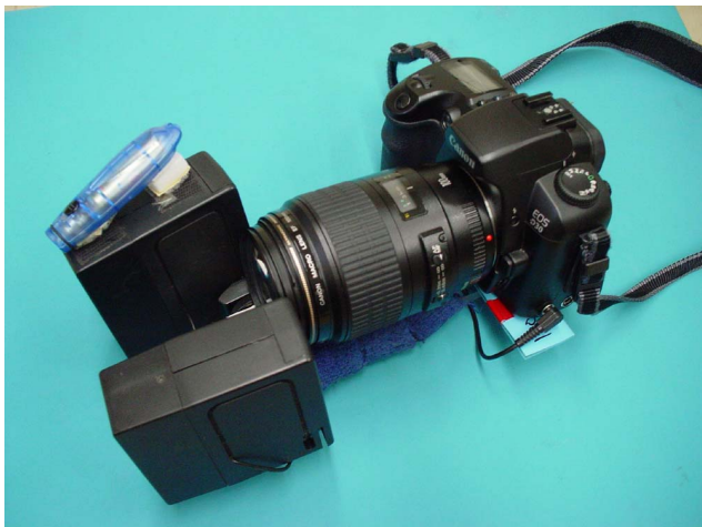
図 4. 今回開発したデジタル蛍光撮影装置
