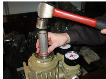
図20. AC6205LLU ベアリングの挿入
