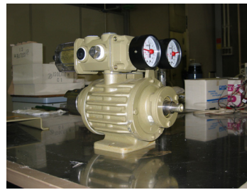
図8. 冷却ファン取り外し
