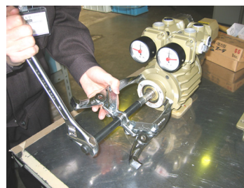
図12. ギヤプラーをかけベアリングを外す
