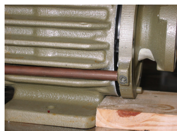
図11. シリンダからサイドプレートAを離す
