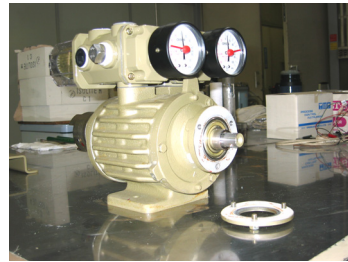
図9. ベアリング押さえを外す
