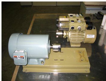
図6. ドライポンプをベースから取り外す
