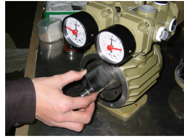
図17. シリンダにロータとブレードを挿入
