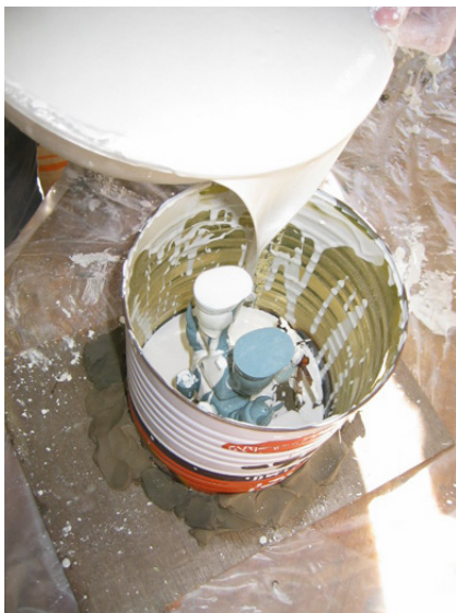
図 4 原型を壊さないように石膏を注入してゆく。
