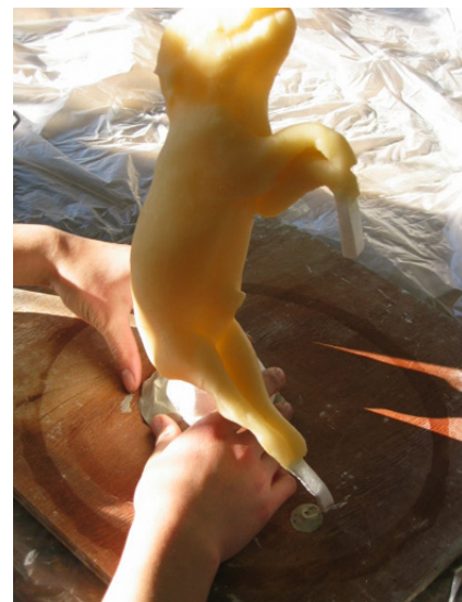
図1 ワックスでつくった原型に湯口、湯道をとりつけている。
