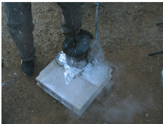
図 10 加圧の様子。溶湯が下にこぼれだしている。
