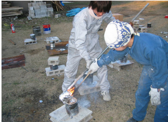
図 9 注ぎはじめは、木の棒で酸化膜を切る。不純物が混入しないように、棒は先端を燃やして炭化させたものを使う。
