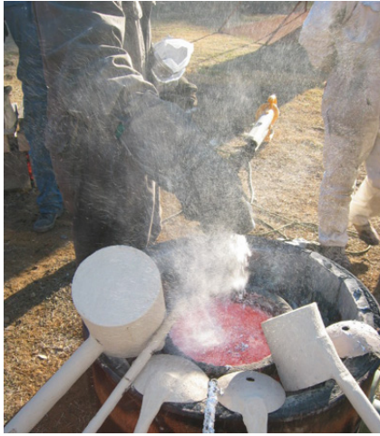
図 8 溶解したアルミニウム合金に食塩を添加する。
