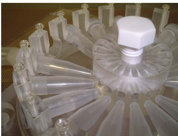
図8 完成したサンプルホルダー中心部は、それぞれの容器への給水口となる穴が円柱部に開いているのが見える。
