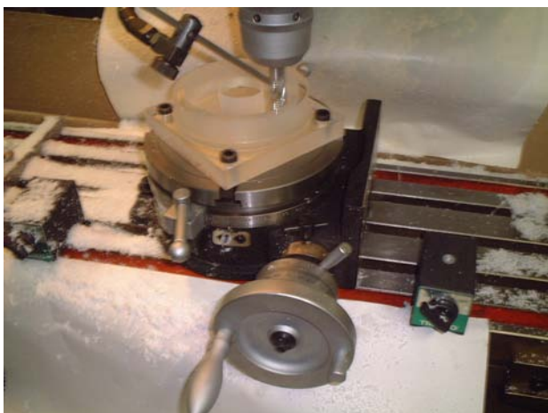
図6 エアブローによる溝加工
