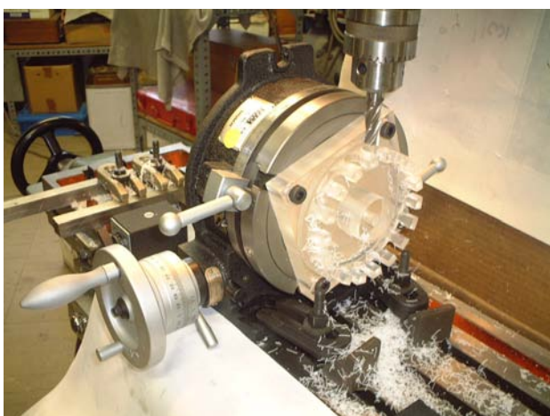
図7 外周部の穴と円柱部のサンプル容器の底が入るくぼみと、水路となる穴を加工しているところを示す。
