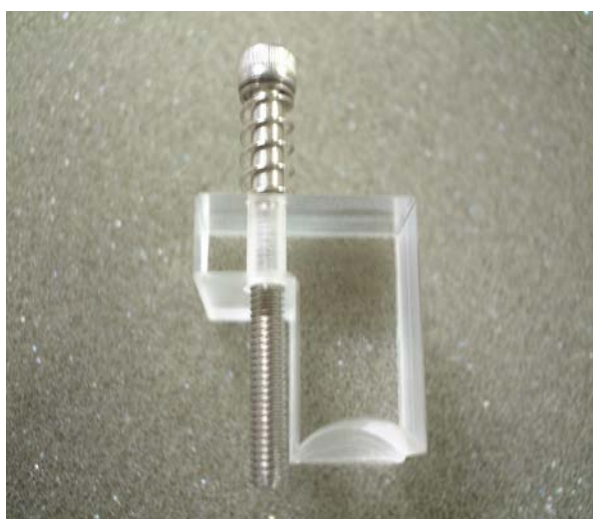
図 4 バネを利用して容器の着脱を容易にした蓋押え部品
