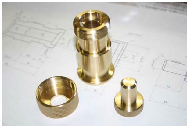
図6 加工が完了した真空部品
