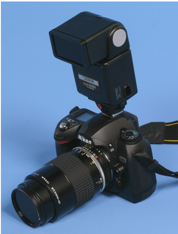
図 4、デジタルカメラに、紫外線撮影用レンズとフィルター、そして、紫外線撮影用フラッシュを使用した、紫外線撮影装置の全景
