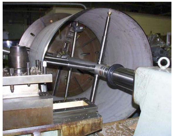
図5. パイプ端面切削加工の様子
