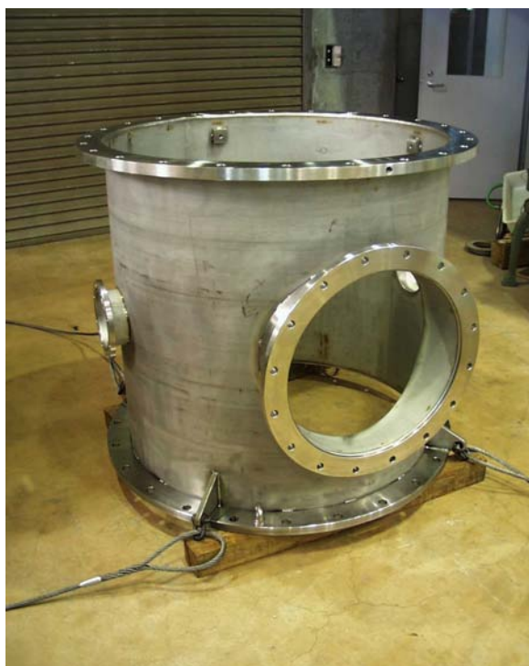
図 6. 完成した NBI 入射タンク延長管
