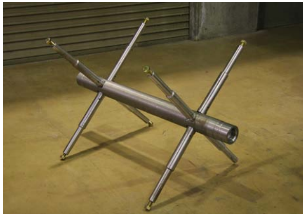
図4. 製作したパイプ保持具
