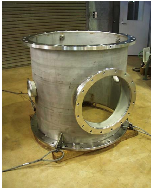
図 6. 完成した NBI 入射タンク延長管
