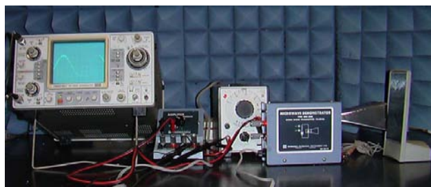
図 7. ドップラーレーダー実験
