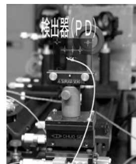
図 9. 実装の一例 光ビート法によるレーザ分光信号検出用 フォトダイオード
