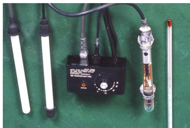
図 2. 水中用ヒーターと電子サーモスタット
