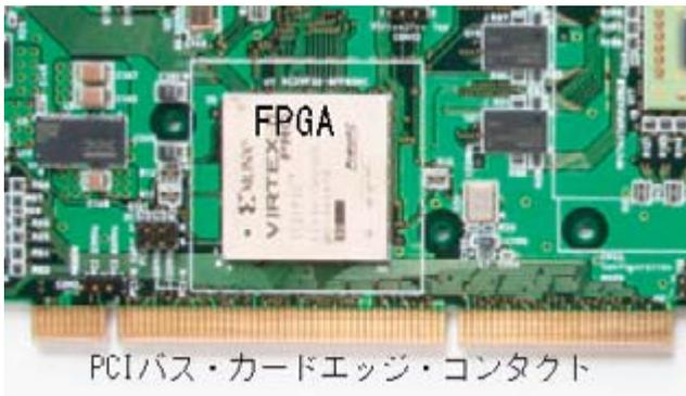
図 7 Maestro3NI の PCI バス、FPGA 部分
