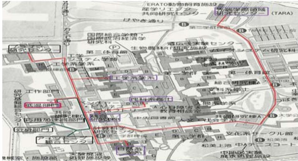
図2. ヘリウム回収配管
