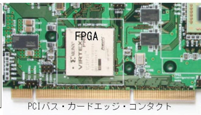
図 2 Maestro3NI の PCI バス、FPGA 部分
