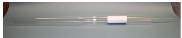
図9-1. ノズルの仮固定
