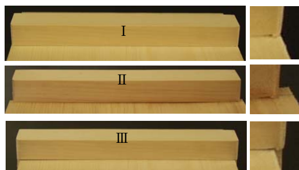
図 7. 足付きまな板の膨潤と収縮 I : 気乾、 II : 水着け、 III : 乾燥
