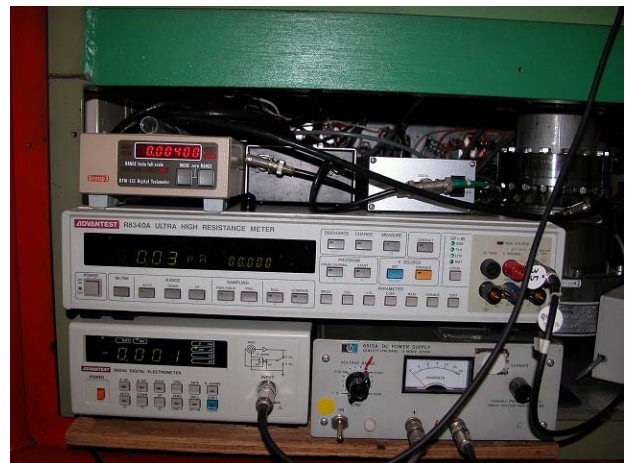
図5. 電流積分のためのピコアンメータ
