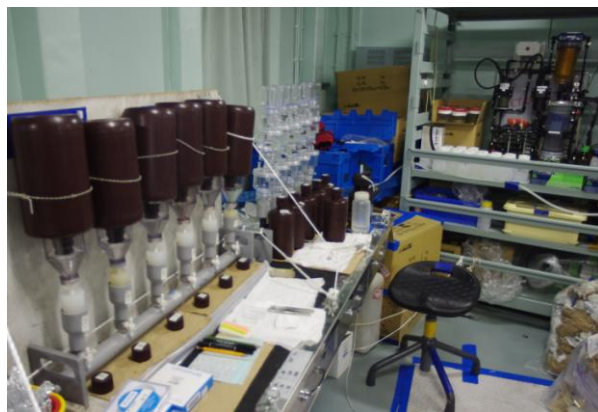
図3. 第4観測室にて海水のろ過処理中 表層モニタリング装置（写真右上）
