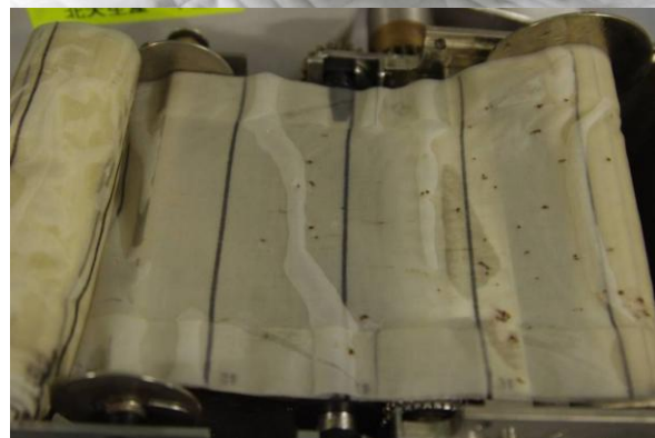
図 6. CPR 本体 (上) と CPR カセット (中) カセットに取り込まれたプランクトン (下)
