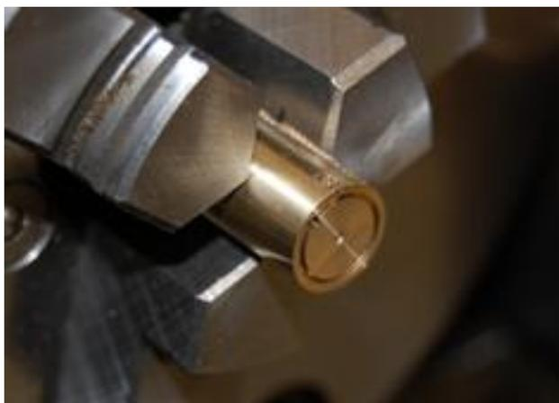
図 6. 溝入れ、ネジの下穴、ステンレスパイプ差込口の加工が完了したところ
