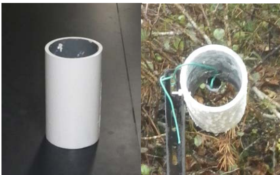
図 12. 改良したロガーフード (右側：中には温度ロガー)
