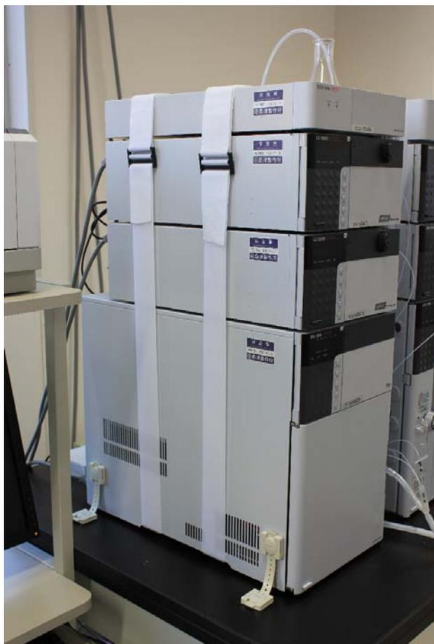
図10. 液体クロマトグラフの固定
