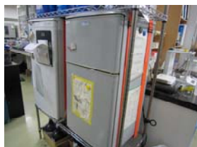
図 14. 実験機器と冷蔵庫の固定例
