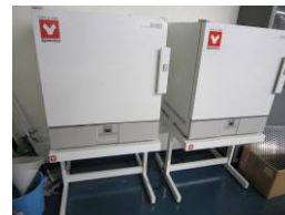
図 6. 2B 棟 3 階学生実験室の落下した恒温器と改善例
