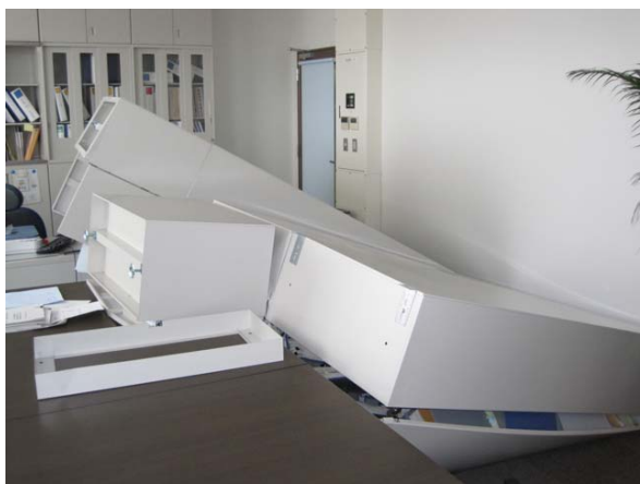
図 9. 重量バランスの悪さによる転倒
