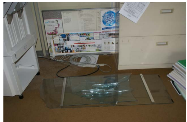
図 18. 落下して破損したガラス戸
