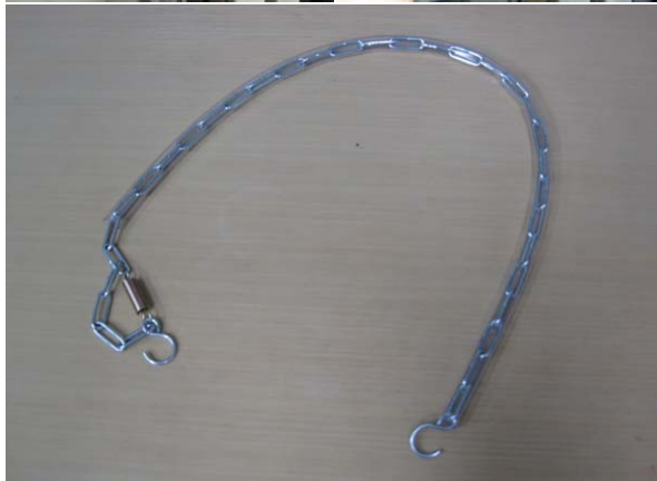
図 24. 金属チェーンを用いた落下防止器具
