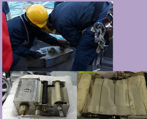
図5. CPR本体(上)とCPRカセット(下左)カセットに取り込まれたプランクトン(下右)
