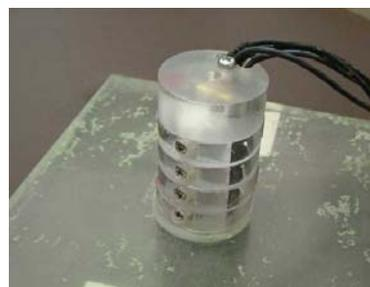
図 8. 製作した 1 N ロードセル
