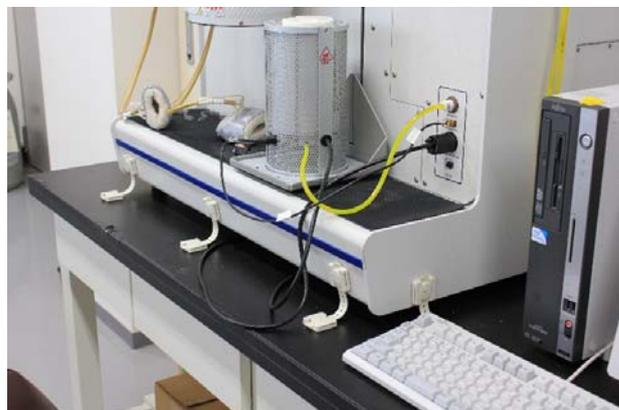
図8. 自動吸着量測定装置
