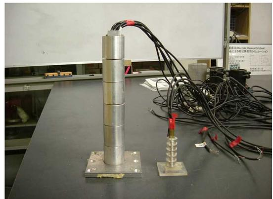
図 3. 製作した杭形ロードセル
