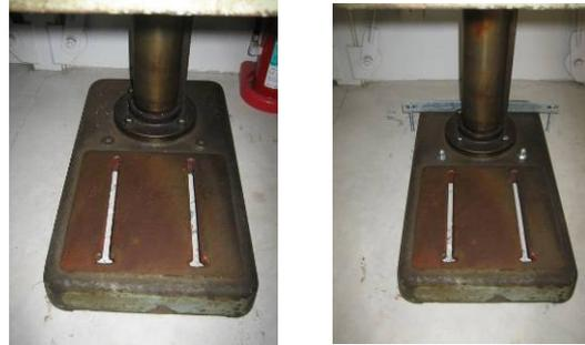
図 25. 移動したボール盤(左)とボルト固定後(右)
