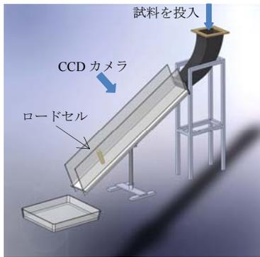
図 4. 小型水路実験の概要
