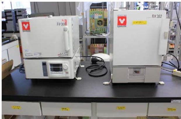
図9. マッフル炉と恒温乾燥器の固定
