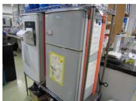
図 14. 実験機器と冷蔵庫の固定例
