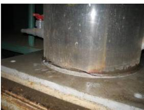
図 23. 割れた沈降管
