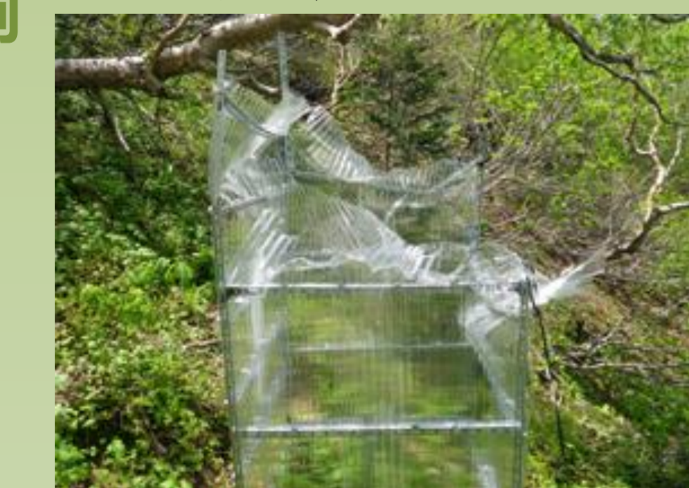
図12 落雪による破損。2011年7月。
