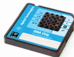
図 1. DNA1000 チップ サイズ 5 cm × 5 cm 調整ゲル 9 μl とサンプル 1 μl は直径 3 mm のサンプル孔に注入する
