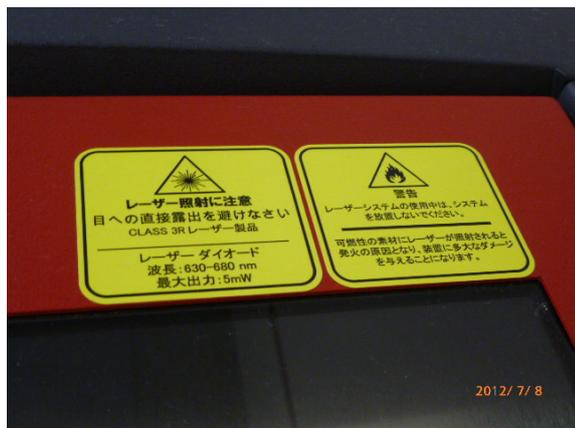
図 10. CLASS3R (CLASS4) レーザー機器
