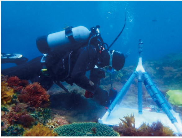
図 4. スキューバ潜水によるセンサー取り付け用の櫓の設置。
