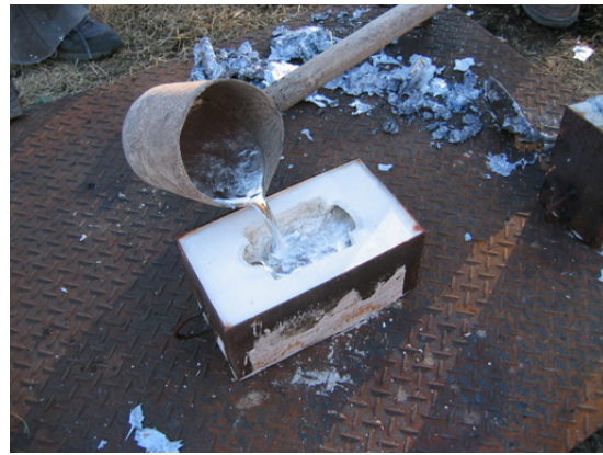
図9. 石膏が冷えないうちに鋳込む
