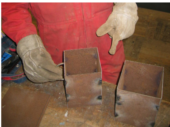
図2. 原型に合わせて鋳型枠を製作する
