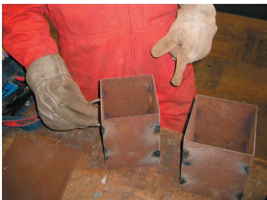
図2. 原型に合わせて鋳型枠を製作する
