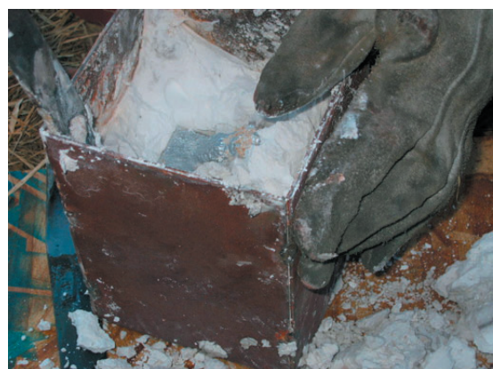
図10. 石膏をかき出して铸物を取り出す
