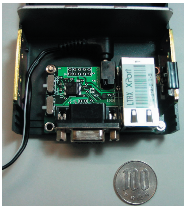
図 7. LANTRONIX Xport mini ユニット (A4 印刷でほぼ実物大)
