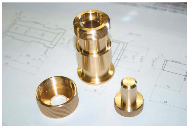
図6 加工が完了した真空部品
