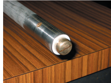
図11. CV170パッキン取り付け部
