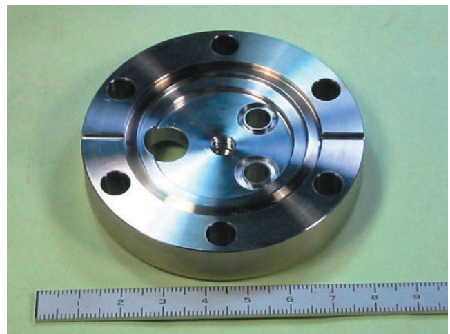
図 4. 切削加工後のフランジ
