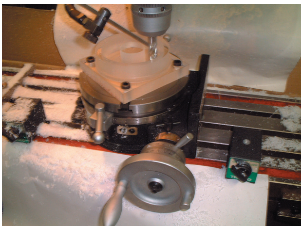
図6 エアブローによる溝加工
