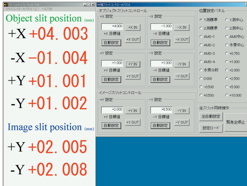
図11. ビームスリットコントロール画面
