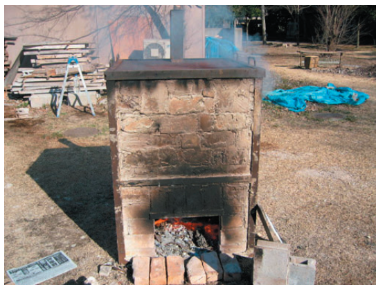
図4. テスト運行兼のモルタル焼き締め
