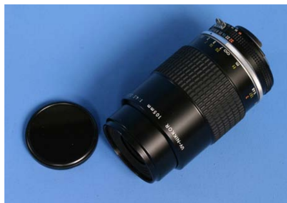
図 1、紫外線撮影用レンズ・ニコンUVニッコール 105mm レンズと、ケンコー社製紫外線透過可視光吸収フィルターU360
