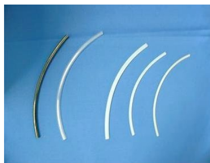
図11. チューブの選定 左から、 ポリウレタンチューブ(4×6) ビニールチューブ(4×6) LABRAIN SILICONE TUBE (4×6) LABRAIN SILICONE TUBE (3×5) LABRAIN SILICONE TUBE (2×4)
