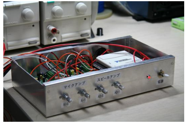
図5 USB-6009 と信号増幅回路
