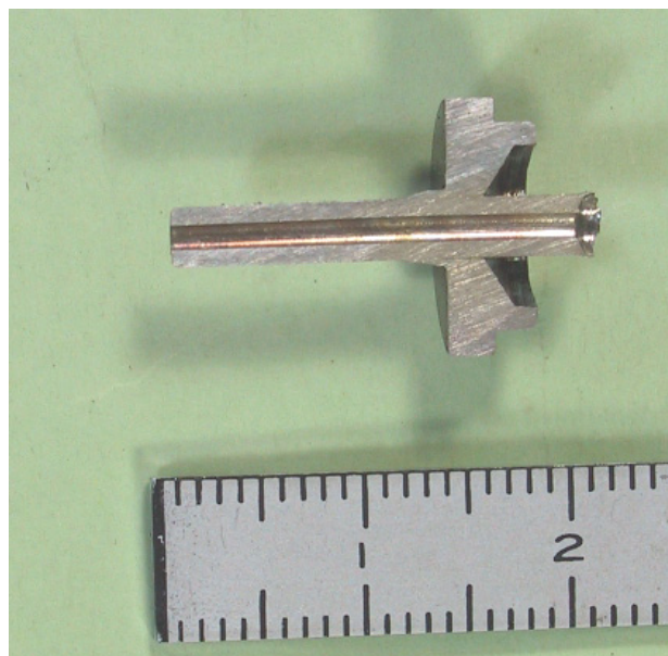
図6. アダプターと管の溶接が成功した物 これは、適当な電流と送りにより成功した溶接。
