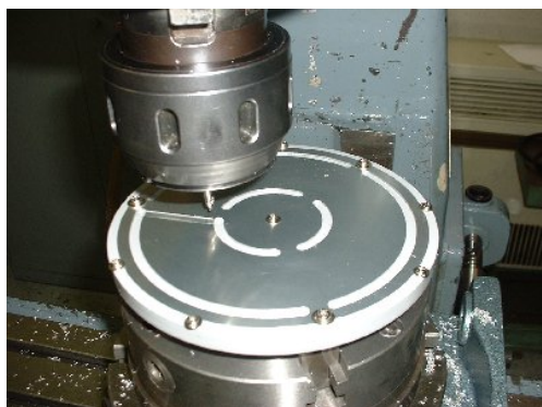
図8. アルミニウム円盤の加工
