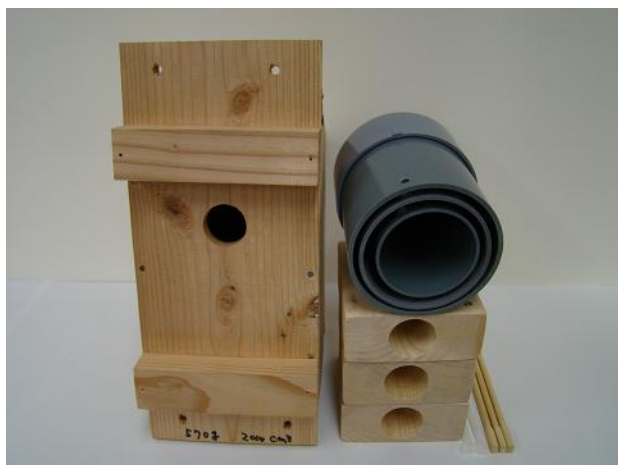
図8. 既製品の小動物用木製巣箱(左)と3個分の塩ビ木製巣箱材料(右)の比較
