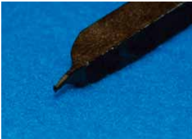
図 4. 自作した溝入れ用のバイト
