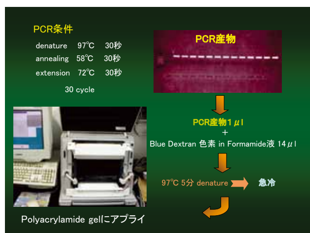
図2. PCR反応とALF express DNA sequencerを用いたpolyacrylamide gelによるSSCP分析法
