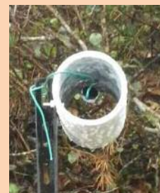
図13 現場に設置したロガーフードとロガー
