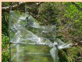
図7 落雪の被害を受けたOTC
