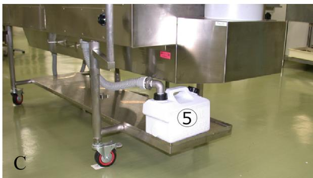
図 7. 局所排気装置付解剖台
