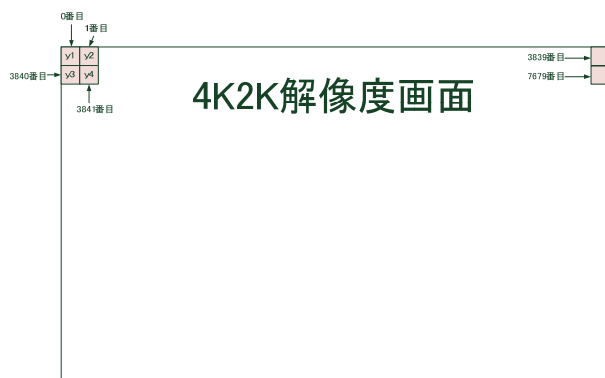
図 9. HD 解像度画面のピクセルの番地
